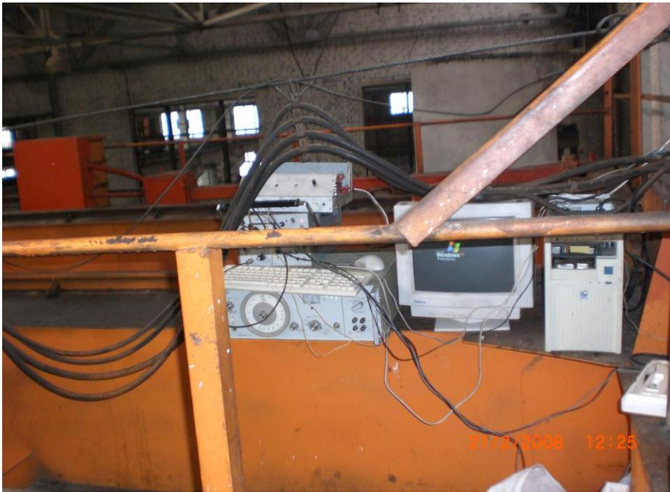
**Рис. 2** - Установка измерительной аппаратуре на мостовом кране.
