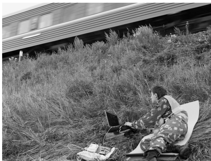
Рис. 4. Рабочий момент замера колебаний насыпи при движении пассажирского поезда
