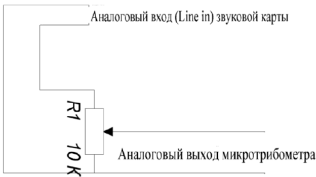
Рис. 1. Схема подключения микротрибометра к компьютеру
