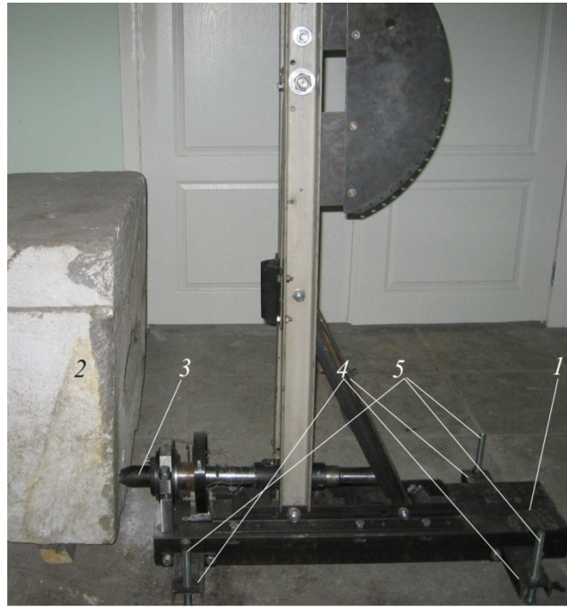
Рис. 2. Маятниковый стенд и мраморный блок: 1 — укороченный швеллер-основание; 2 — мраморный блок; 3 — клиновидный инструмент; 4 — лапы; 5 — болты
