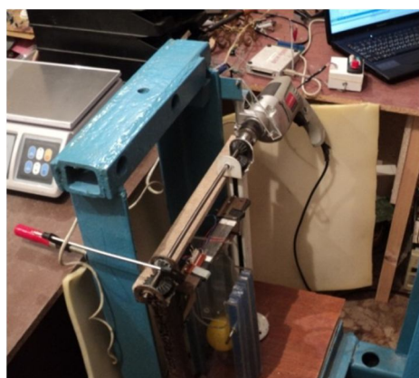
Рисунок 2 – Испытательный стенд для определения прочностных свойств плодов, овощей и корнеплодов: 1 – станина; 2 – стойка; 3 – электродвигатель; 4 – приводной вал; 5 – муфта; 6 – спаренный механизм вертикального перемещения; 7 – режущий аппарат; 8 – тензометрическая балка восприятия нагрузок; 9 – пуансон
