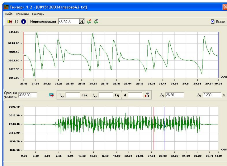
Рисунок 5 – Фрагмент сигнала, записанного датчиками ТДА-5001 для вычисления скорости движения и нагрузки на ось подвижного состава
