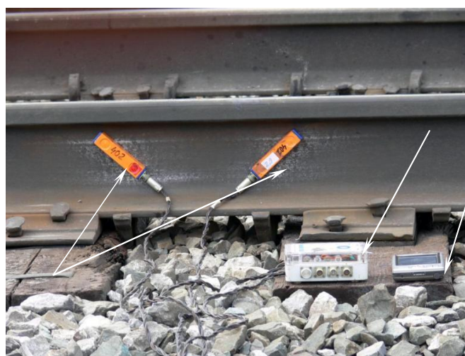
Рисунок 4 – Общий вид оборудования и схема крепления датчиков к шейке рельса для замера скорости движения поездов и осевой нагрузки: 1 – датчики ТДА-5001; 2 – блок усиления и преобразования сигнала; 3 – блок приема и хранения сигнала
