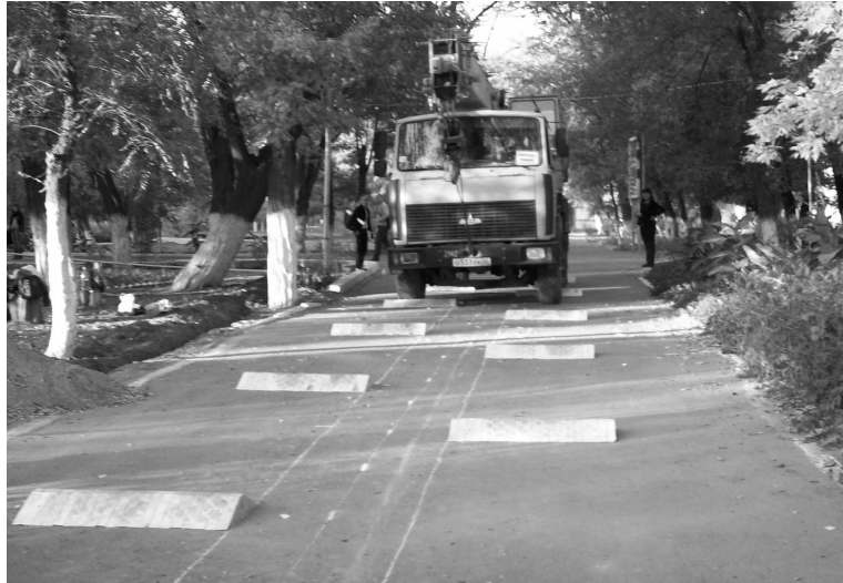
Рис. 3. Экспериментальное исследование автомобильного крана КС-35715 (кран перемещается по искусственным дорожным неровностям, расположенным в шахматном порядке)
