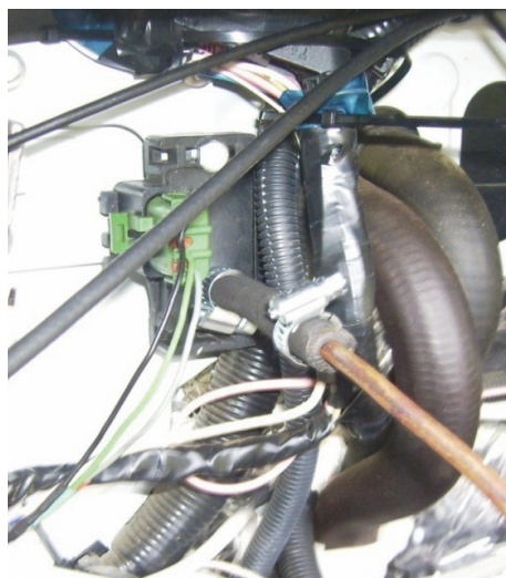
Рис. 3. Установка датчика давления наддува
