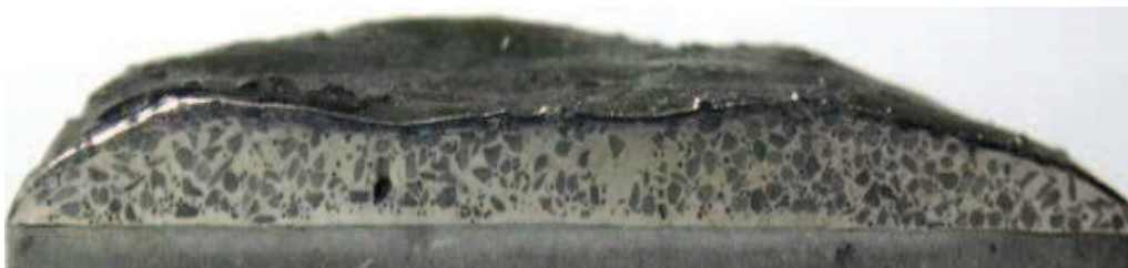
Рисунок 11. Структура образца № 1: наплавка шнуром состава 60WC 40Ni без подслоя никеля
