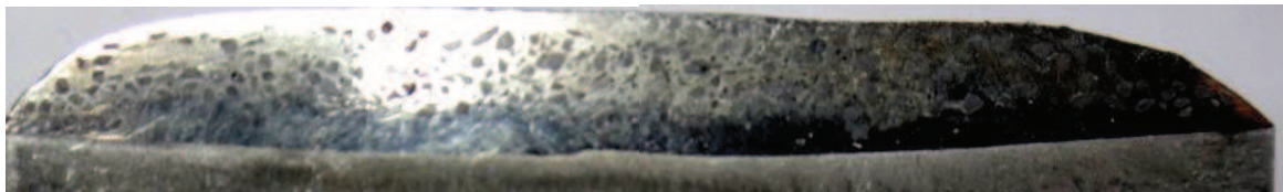
Рисунок 13. Структура и дефектность образца № 4: наплавка с подслоем Ni + шнур 60WC 40Ni
