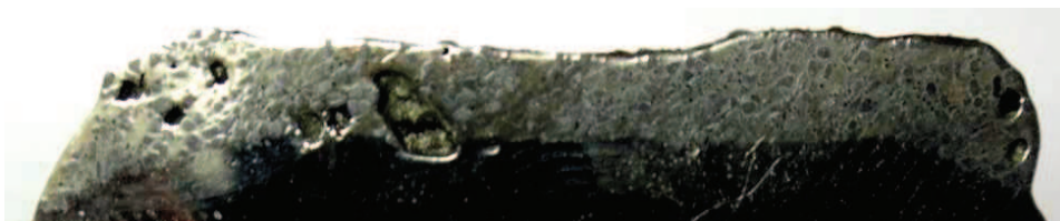
Рисунок 12. Структура образца № 3: наплавка шнуром состава 60WC 40Ni с подслоем никеля толщиной до 1 мм
