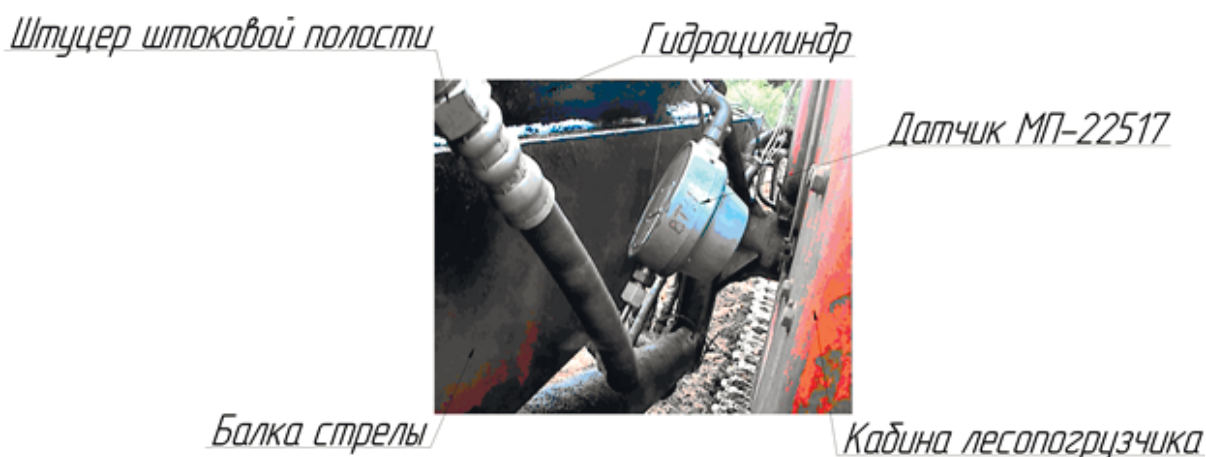
Рисунок 2 – Установка преобразователя давления МП-22517 в гидросистему
