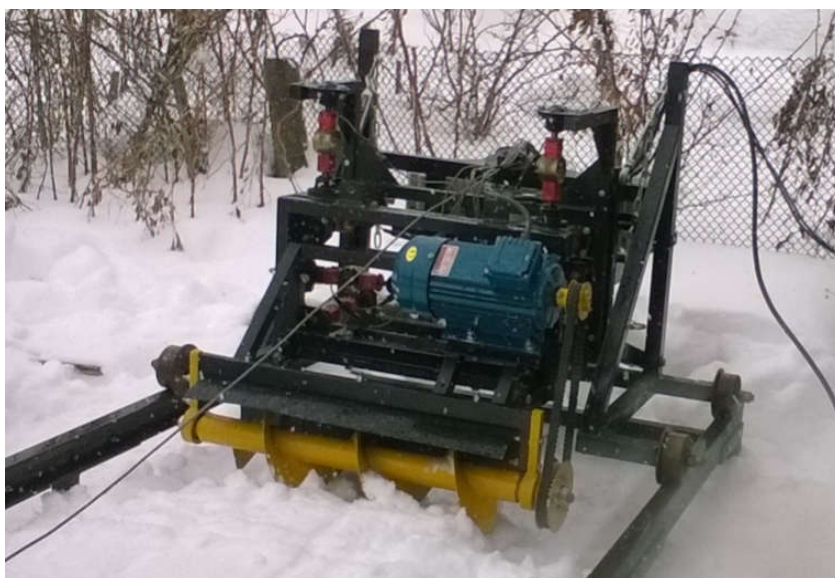
Рис. 1. Лабораторный стенд «Грунтовый канал» со шнековым питателем
