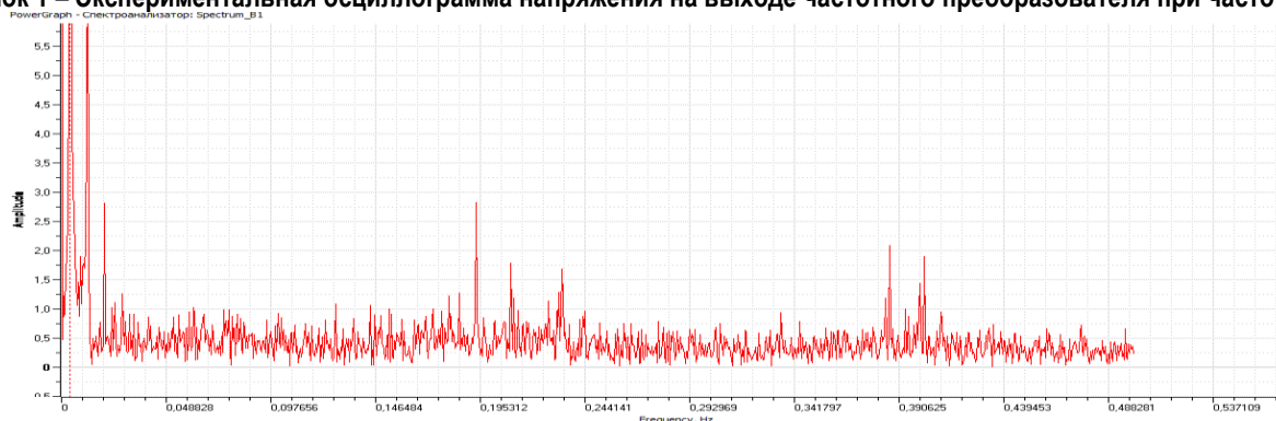
Рисунок 2 - Спектр напряжения двигателя 50 Гц
