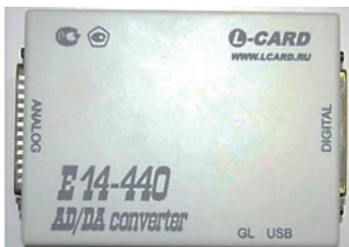
Рис. 1. Аналого-цифровой преобразователь E14-440
