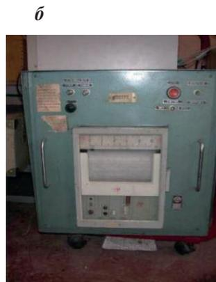
Рис. 3. Штатное оборудование для контроля момента трения машины трения СМЦ-2:
