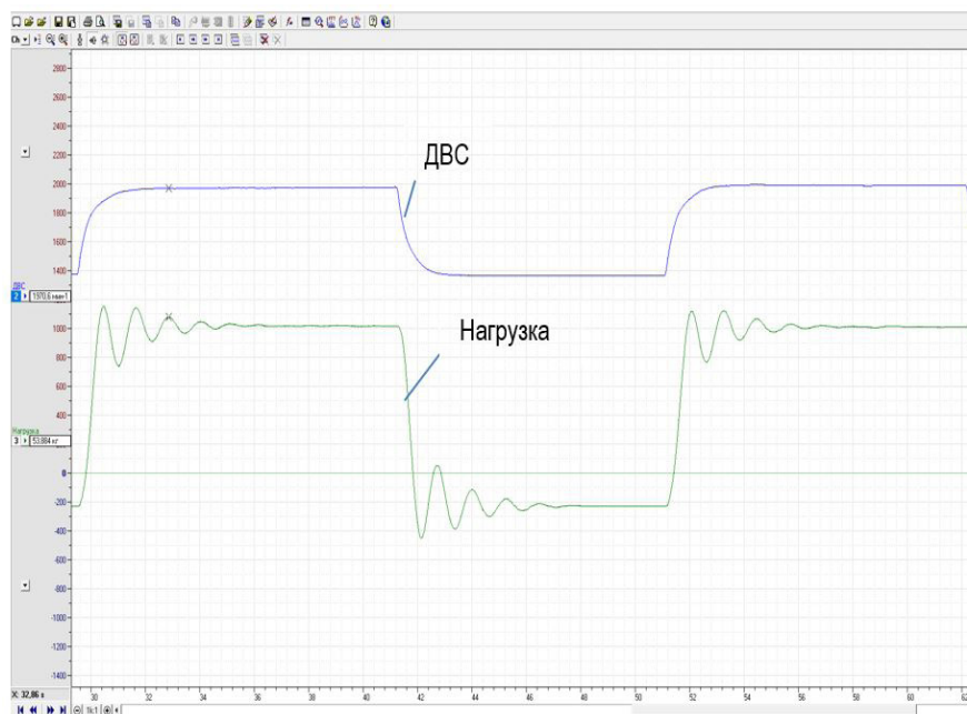
Рис. 4 – Запись переходных характеристик двигателя Д-245-35 на модернизированном стенде КИ-5543 ГОСНИТИ (под нагрузкой)
