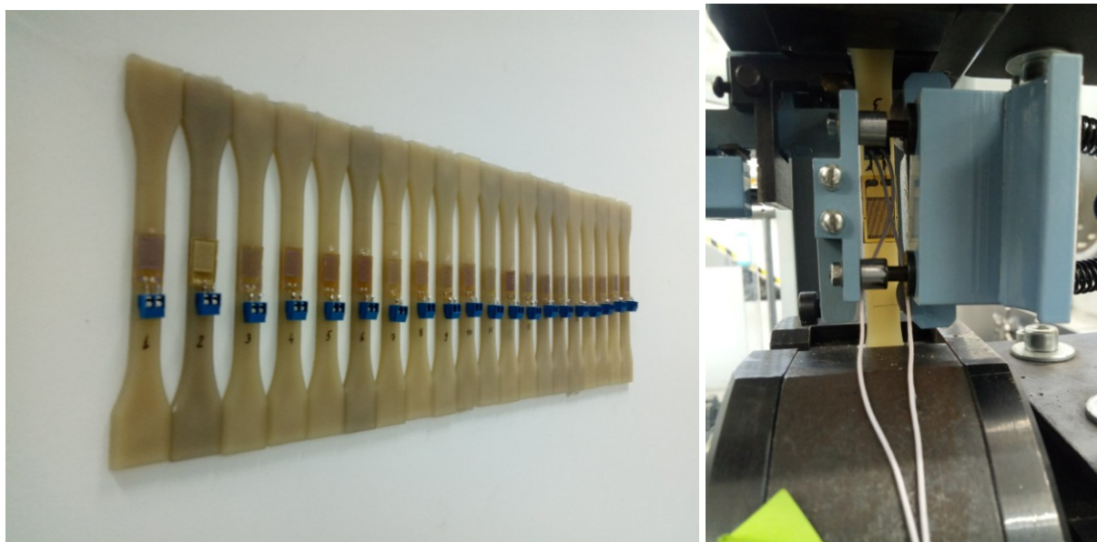
Рис. 5. Образцы для тарировки с наклеенными тензорезисторами (слева) и образец с установленным экстензометром
