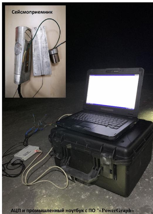
Рис.3. – Сейсмоприемник (ГЕОМЕХ): ПО «PowerGraph», АЦП и сейсмоприемник С1-30 в клиновом устройстве, используемые в ходе экспериментальных работ
